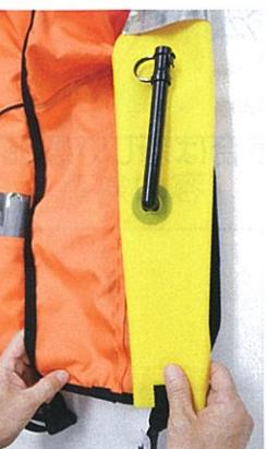
⑦ ④で折り畳んだ右側の気室本体の下に本体保護カバーを中心から外側に向かって滑りこませ、気室本体と本体保護カバーを面ファスナーで留めます。面ファスナーは、本体保護カバーの面ファスナーが外側に約1cm余るように留めてください。
