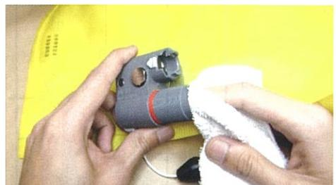
3 新しいスプールを装填する前に、装置本体と卷上キャップ内部の水分を取り除き、十分に乾燥させてください。
