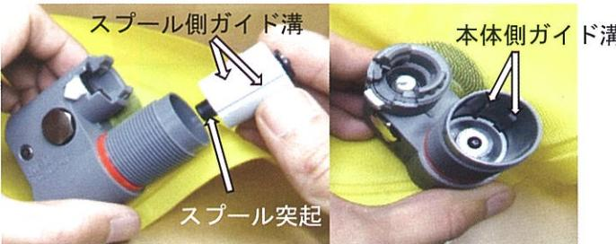
5 新しいスプールを装填します。スプールの突起を下にして、ガイドに沿って装置に入れてください。
