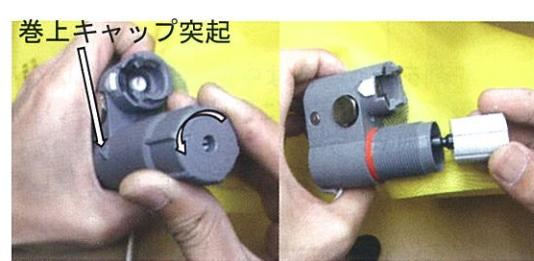
2 卷上キャップを反時計回りに回転させて取り外し、本体内部の使用済みスプールを取り出します。
