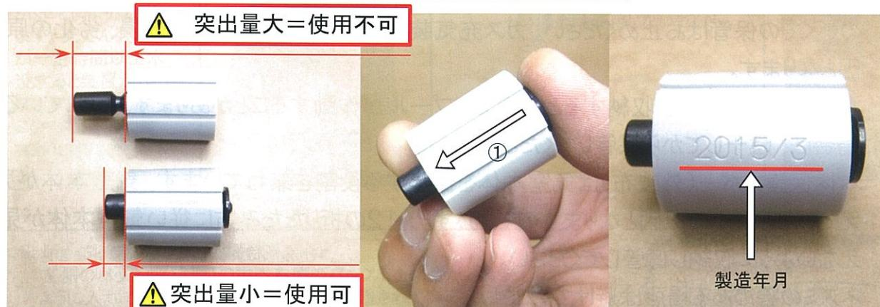
※ スプール装填時に軸棒の突出量が大きい場合には使用不可、突出量が小さい場合は使用可となります。
